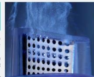
EOCIS(EO electrolysis circulation system) 電極板に電圧がかけられ、電解液が循環している様子
